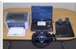
本機器は、運転適性診断車搭載の運転操作検査器と同等の機能を有し、いつでもどこでも空き時間を利用してドライバーの「運転操作検査」を行うことができる検査器です。短時間で簡単に検査ができ、かつ、検査後即時に解析データが得られます。検査に必要な機器類(ハンドル・ペダル・パソコン・プリンター)はハードスーツケースに収納できる小型・軽量のコンパクト設計で持ち運びに大変便利であらゆる場所での検査が可能です。近畿交通共済では、このアクセスチェッカー・ミニを契約組合員の皆様へ無料で貸し出しを致します。ご利用の際は、当組合職員が搬入と回収を行い、親切・丁寧に機器の設置から取り扱いの説明まで行います。ドライバーに対する安全教育、交通事故防止にぜひご活用ください。
